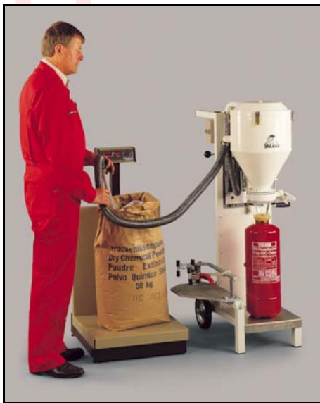
Neubefüllung von Feuerlöschern
