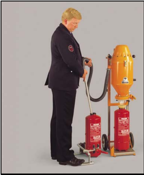
Umfüllen von einem Feuerlöscher zum anderen ( Serienprüfung gleicher Feuerlöscher )
