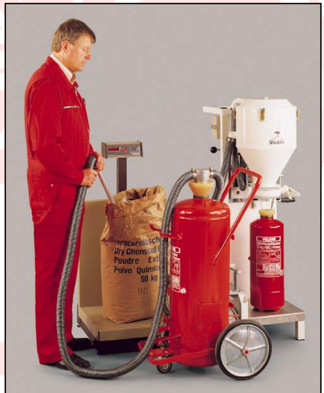
Befüllung fahrbarer Löschgeräte mit Universal -Vorabscheider VA 230
